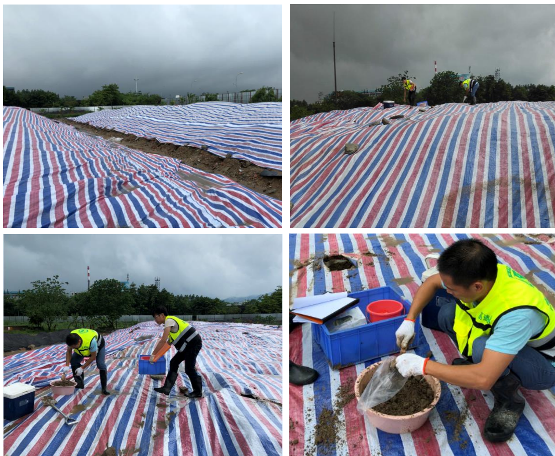
图 20：修复养护的土堆及现场采样
